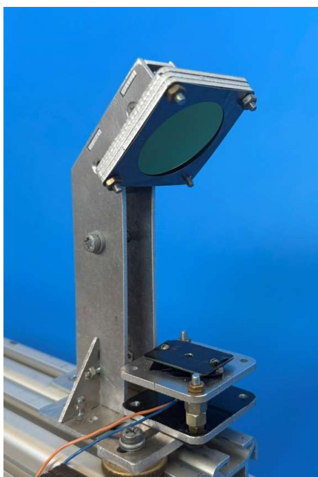
Рис. 3. Поворотное зеркало, маска и термоэлектрический детектор в оптической системе экспериментального стенда (см. рис. 2)
