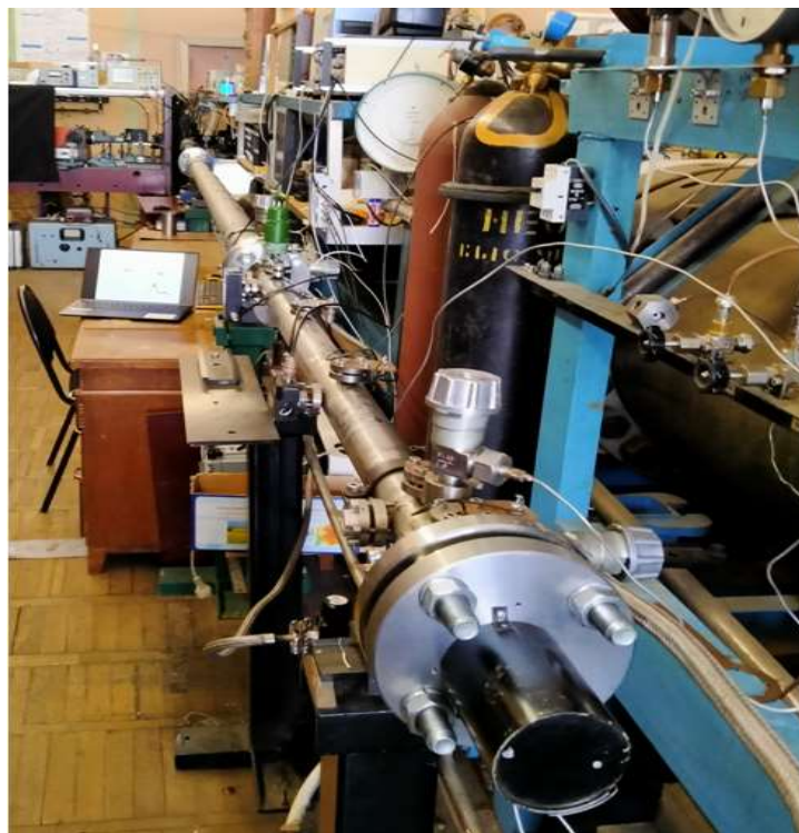
Рис. 1. Общий вид двух-диафрагменной экспериментальной установки DDST-M по измерению излучения ударно нагретого газа
