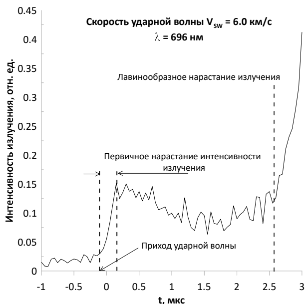
Рис. 4. Начальный этап эволюции излучения при начальном давлении 1 Торр на длине волны 696 нм при скорости ударной волны 6 км/с
